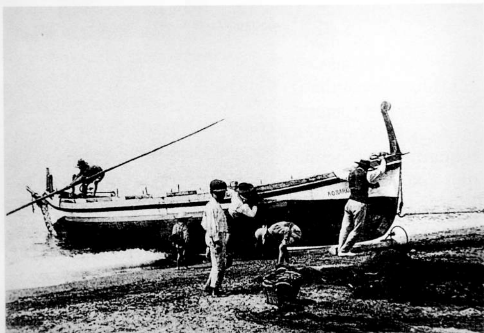
FOTO 12.—Varando la barca, en la proa un marengo se ayuda de la palanca.
