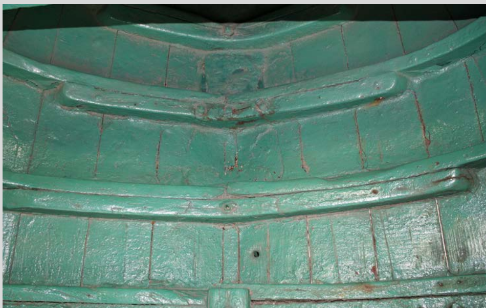
Detalle de las cuadernas 18 a 21 (popa-proa entre el final de la palamora y el castillo de proa) con sus planes y estemelaras y con el bitoque a la banda de proa (estribor) cercano a la quilla. Foto P. Portillo
