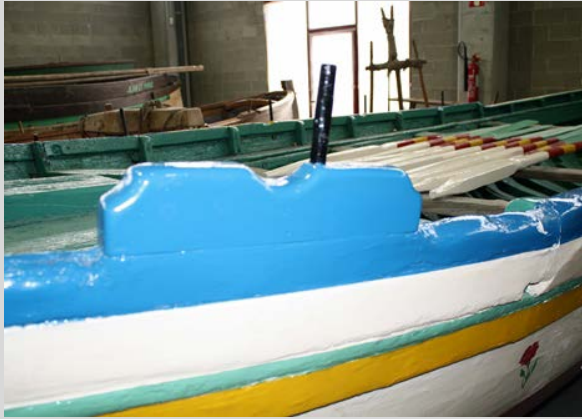
Apoyo elevado del escálaro de corulla en el castillo de proa de la María del Carmen donde podía montarse un noveno remo. Foto P. Portillo
