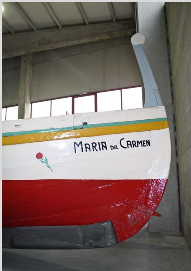
Vista desde la aleta de popa con carenas, borondo bajo la línea de aguas, engarce del tragante a la borda y codaste. Foto P. Portillo
