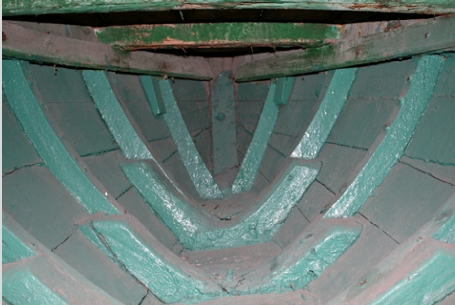
Puntal interior del castillo de proa con la contraroda al frente. Foto P. Portillo
