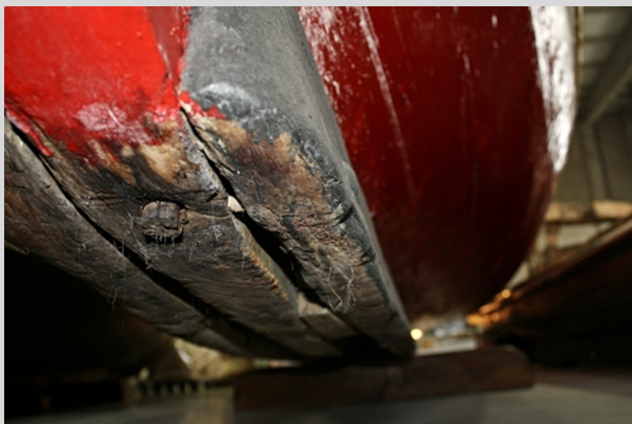
Detalle de la unión de carenas al codaste de popa. Foto P. Portillo
