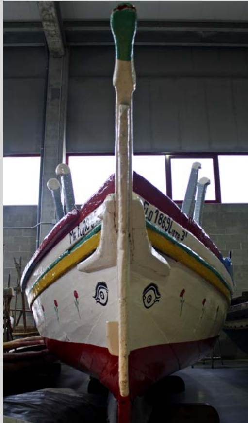
Frente proa de la María del Carmen. De abajo arriba: carenas, obra viva (rojo) y obra muerta (blanco), ojos, champazas de pico, cinta, tabla de llave, tabla de borda, reón, maniquetas y coronando la parte superior la cabeza de serpiente. Foto P. Portillo
