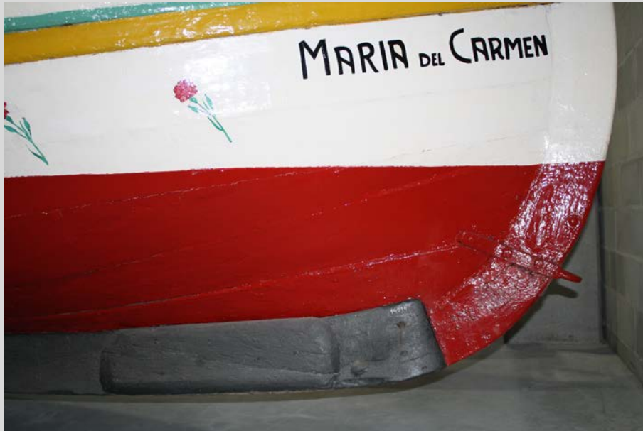
El codaste de popa está construido a dos piezas y se observa la apaladura en la primera bocal junto a la gran carena. Foto P. Portillo
