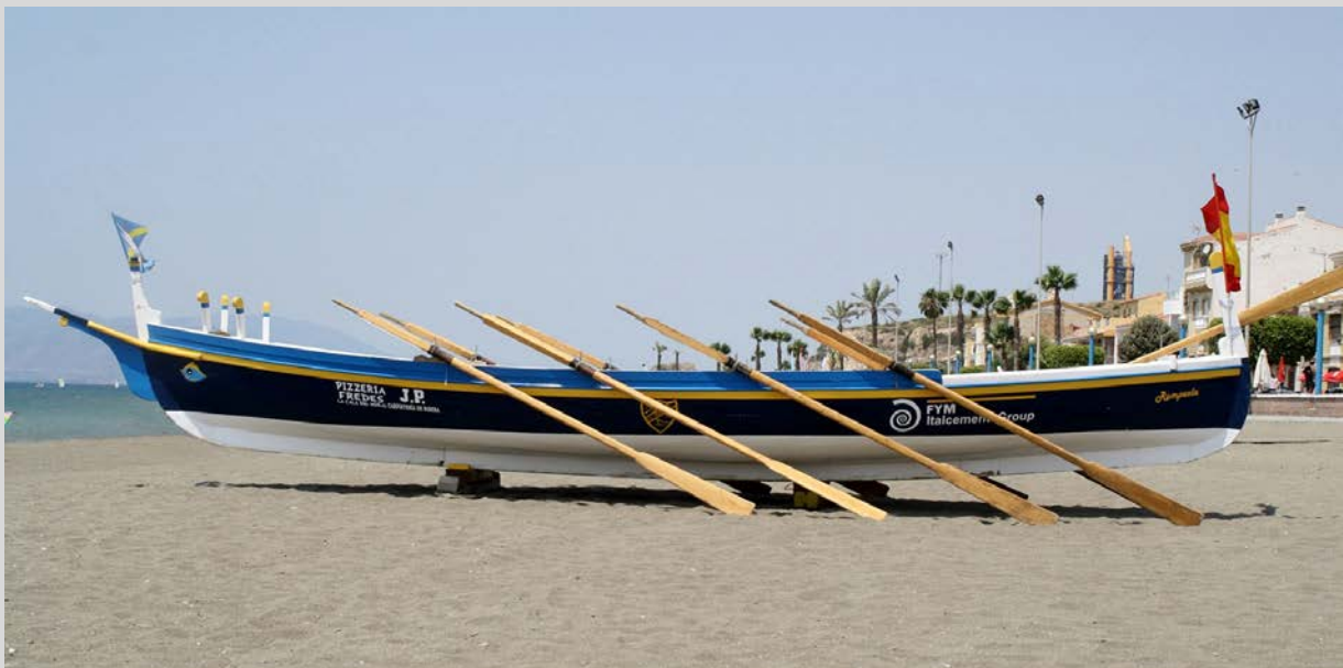
Estilizado perfil de la Rompeola, modelo de barca de última generación, cuyas medidas de altura desde el suelo al caperol o desde el plano de arena hasta el remate del codaste de popa contrastan con las de la María del Carmen, pues la primera es inferior en 26,5 cm a popa y en 36,5 cm a proa respecto de la segunda. Foto P. Portillo
