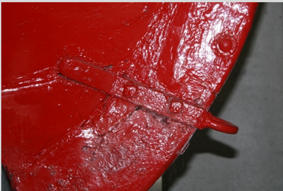
Detalle de la fijación del borondo en el codaste de popa. Foto P. Portillo
