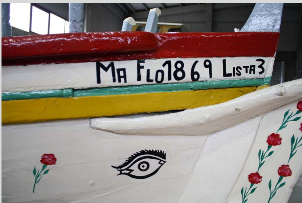
Centrado el ojo por debajo de la champaza de pico y rodeado a derecha e izquierda de claveles rojos (casco y tajamar). Por encima y de abajo arriba del ojo la cinta (ocre), tabla de llave (aguamarina), tabla de borda (blanco -folio-), reón (rojo) y maniquetas. Foto P. Portillo
