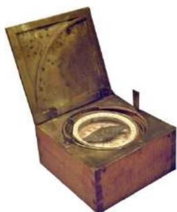
**Brújula azimutal** española del siglo XVIII (MAN). El calificativo “azimutal” hace referencia a su capacidad para medir el arco del horizonte (“azimut”). La aguja magnética va montada en una caja de madera, latón y vidrio. Licencia Creative Commons, atribución Luis García.
