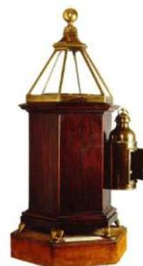
(\*) La **bitácora** es un artilugio de forma prismática fijado a la cubierta de la embarcación junto a la rueda del timón, con aguja magnética montada en suspensión para que a pesar del balanceo y cabezadas del buque se mantenga horizontal y señale sin error el norte magnético.
