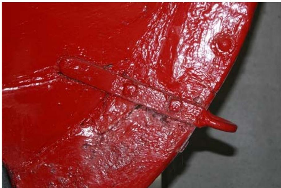
Detalle de la fijación del borondo en el codaste de popa.
