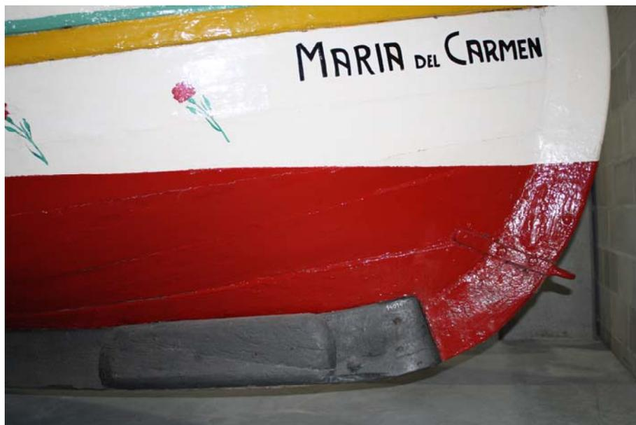
El codaste de popa está construido a dos piezas y se observa la apaladura en la primera bocal junto a la gran carena.
